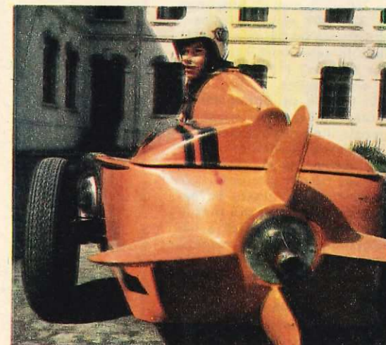
Cea mai recentă realizare a Palatului pionierilor: un miniautomobil de formulă. Datorită liniei aerodi- namice și puterii motorului (200 cmc, 8 CP), poate atinge o viteză de peste 80 km/h.
