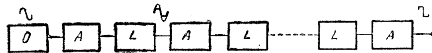
Fig. 16.10. Schema bloc a unui generator de semnale dreptunghiulare, cu amplificări și limitări succesive.
