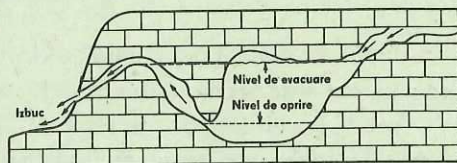
Fig. 92. Schema de funcționare a unui izbuc.
