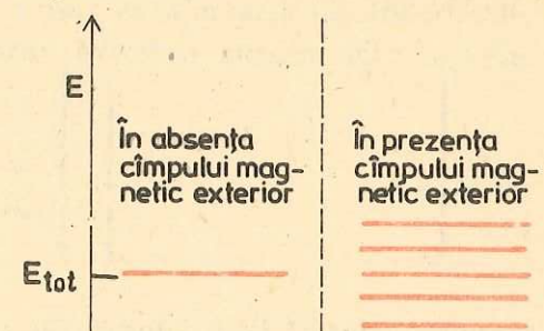
Fig. 2.15. Modificarea energiei totale a electronului în prezența cîmpului magnetic în cazul în care numărul cuantic orbital are valoarea l = 2 . În locul unui singur nivel, apar 2l + 1 = 5 subnivele.
