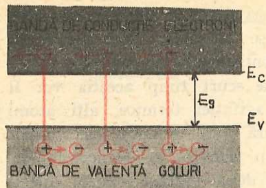
Fig. 3.24. Reprezentarea schematică a principalelor procese fizice care au loc într-un semiconductor cu conducție intrinsecă.
