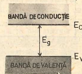
Fig. 3.23. Reprezentarea simplă a benzilor energetice într-un semiconductor.
