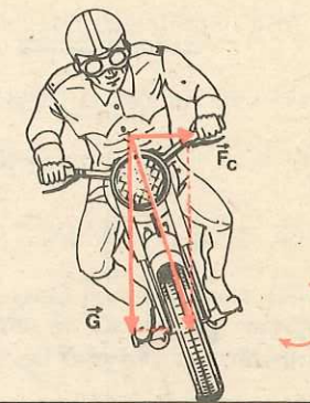
Fig. 3.58. La viraje bicicliștii și motocicliștii se înclină spre centrul de curbă pentru a nu cădea.
